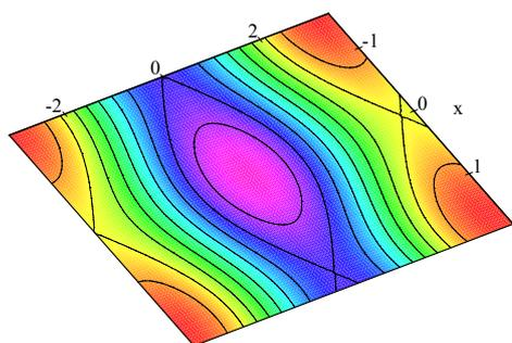
la seconda fornisce la proiezione in piano con le curve di livello: i punti estremanti sono al centro di zone delimitate da curve chiuse; i punti di sella stanno dove le curve di livello si incrociano.
