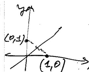
$$\begin{pmatrix} x' \\ y' \end{pmatrix} = \begin{pmatrix} 0 & 1 \\ 1 & 0 \end{pmatrix} \begin{pmatrix} x \\ y \end{pmatrix}$$
