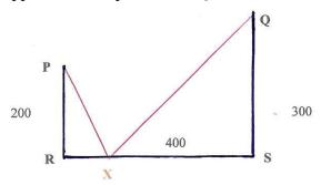
Tra i modi per risolvere il problema è particolarmente interessante quello basato sulla costruzione del punto Q' simmetrico di Q rispetto a S, dato che il percorso più breve PXQ è quello corrispondente a PQ'. Analogamente, si potrebbe prendere P' simmetrico di P rispetto a R.
